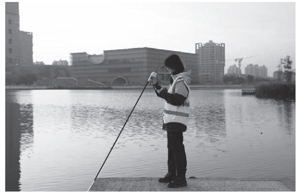
図-3 グリーンレーザーを使用した手持ち測量
