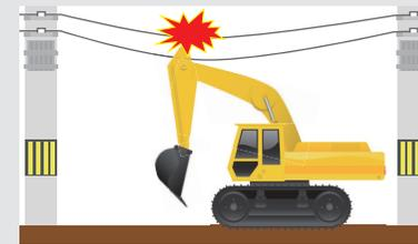
送電線下や高架下作業などの障害物下での作業では、アーム接触により工期・評価に悪影響を与える。架線防護カバーや対策をしてもオペレータからは **認識しづらい**。
