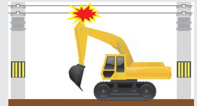
送電線下や高架下作業などの障害物下での作業では、アーム接触により工期・評価に悪影響を与える。架線防護カバーや対策をしてもオペレーターからは認識しづらい。
