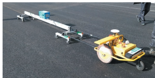
写真-9 自動走行ロボットによる3mプロフィールメータのけん引状況
