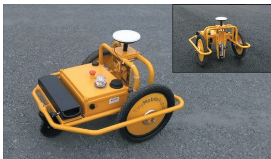
写真-2 自動走行ロボット (右上：後部写真)
