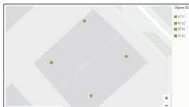
ロケーターワンは橋桁の上に測点として4台配置され、更に変位の影響を受けない離れた場所に基準点が配置されました。
