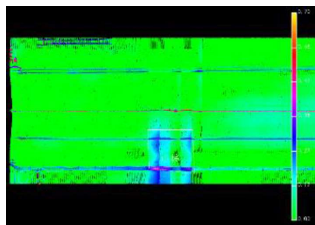
覆工コンクリート表面の凹凸形状を色分け表示し、カラーマップとして可視化
