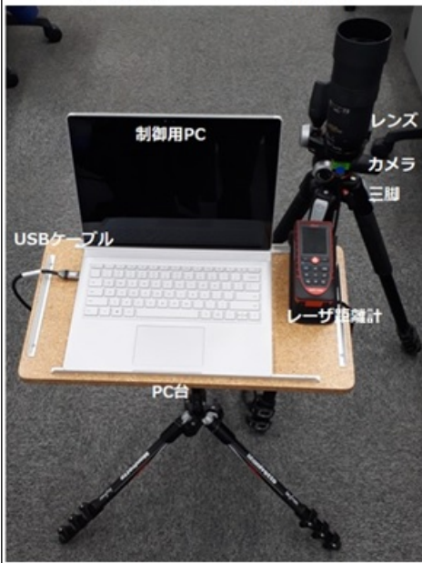
図1 動画像計測システムの基本構成(最小構成)
