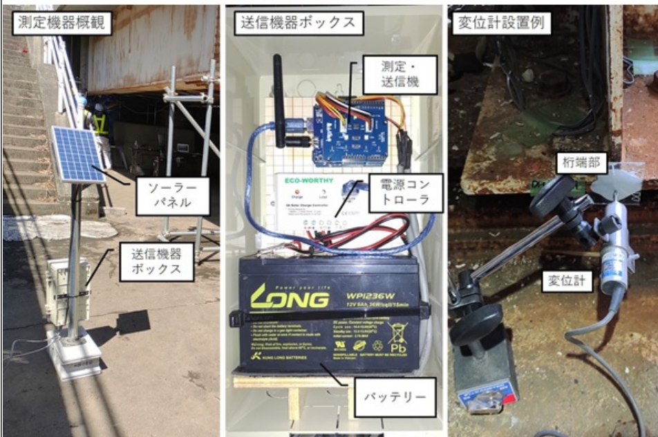
設置概要・送信機器ボックス・変位計設置例
