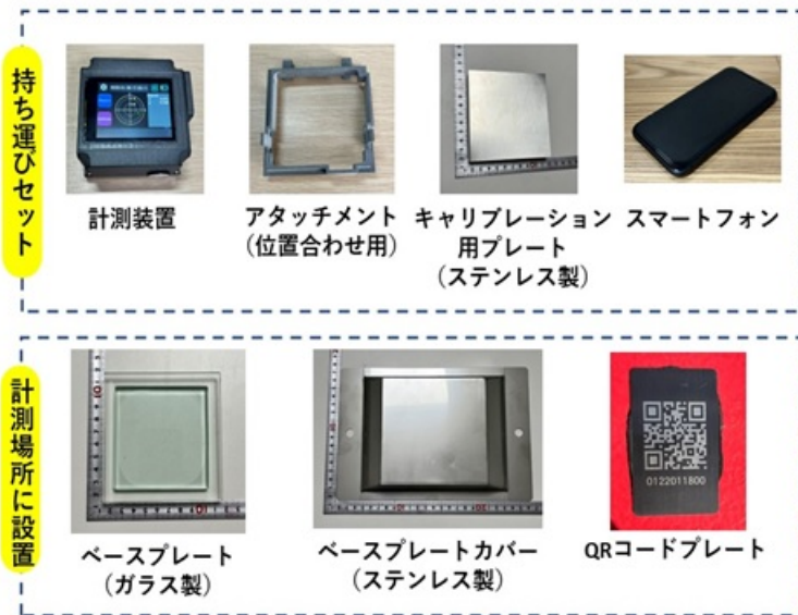
図2 計測機器構成
