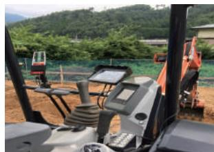
最近は施工精度が厳しくなり荒掘削、碎石敷布時にも精度が要求されるようになりました。1人での作業が多く、特に寒冷地では 40 cm 程度深く基礎を打つ必要があり掘削高の確認や乗り降りが大変でした。
